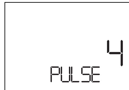
Fig.11 Regolazione impulsi per ogni giro ruota
