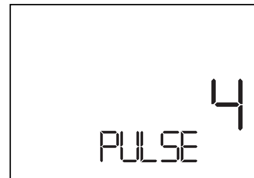
Fig.11 Regulación de impulso por cada giro de rueda para enduro y supermotard siempre (4)
