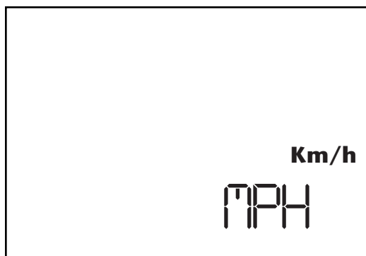
Fig.10 Regulación de unidad de medición
